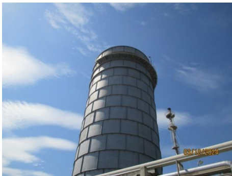
รูปที่ 3-5 หอเผาทั้งระดับเหนือพื้นดินแบบมิดชิด (Enclosed Ground Flare)
